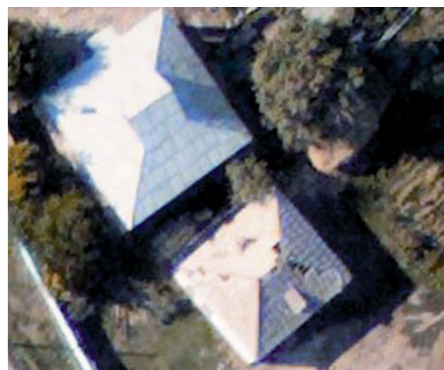
Рис. 2. Ограничения применения способа определения высот зданий по теням: а – съемка в пасмурную погоду; б – затруднено определение четких границ тени
