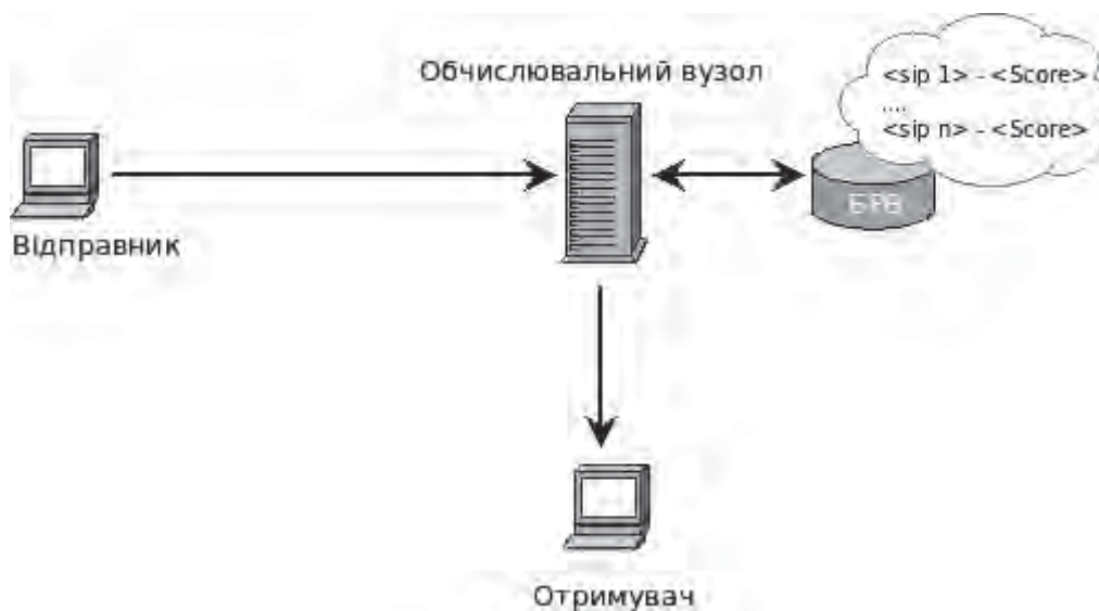
Рис. 1. Етапи встановлення довірених відносин між відправником та обчислювальним вузлом
