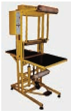
Установка пакування групових виробів у рулону плівку. Модель УП-3
