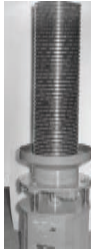
Вібропідйомник ВНП-200, призначений для піднімання і накопичення заготовок голок паливного насоса в автоматичній лінії
