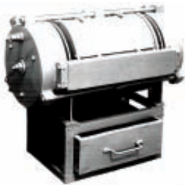
Вібраційна машина об'ємної обробки
