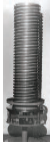
Універсальний вібраційний живильник-підйомник, призначений для широкого діапазону типорозмірів деталей
