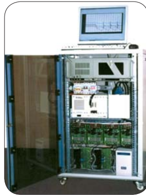
Система розпізнавання технологічних стадій та оптимального керування режимами плавлення в дугових печах на основі нейронної мережі
