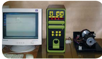
Генератор змінного струму з постійними магнітами для вітроенергетичної установки
