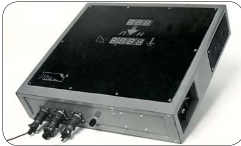
Експериментальний взірець системи керування електроприводом глибинонасосної установки видобування нафти
